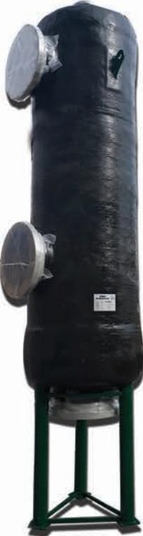
مخازن فیلتر شنی و کربن اکتیو یکی از سیستم‌های ابتدایی تصفیه آب می‌باشند که باعث کاهش کدورت آب (پارامتر NTU) و حذف ذرات معلق (TSS) تا سایز ۵۰ میکرون می‌شوند. این مخازن تحت فشار از سیسلیس با دانه بندی مختلف (فیلتر شنی) و یا کربن و سیسلیس (فیلتر کربن اکتیو) پر شده و باعث کاهش بو و طعم آب می‌شود که در مرحله پیش تصفیه آب کاربرد دارد.
